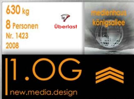
Anzeige aller Aufzugsdaten, Herstellerlogo, Sondertexte - Überlast, Notrufpiktogramme etc. Etagenstand - Etageninformation, Fahrtrichtung
