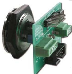
Platine mit Flachbandkabel-Anschluss
