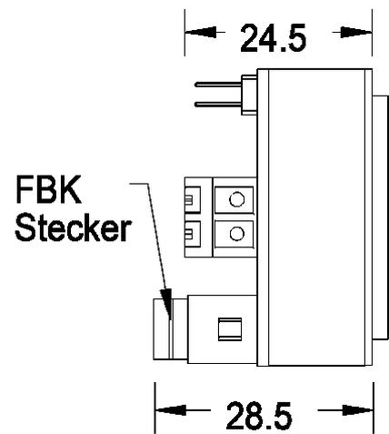
Anschluss Flachbandkabel 10 polig
